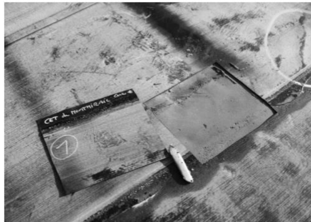
Prélèvement d'un échantillon de soudure pour essais en laboratoire
